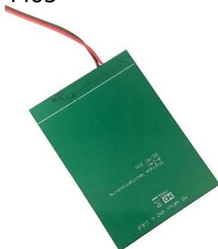
**WHZ (Weichenheizung digital/analog wetterfest vergossen mit Regelsystem und intelligenter Temperaturüberwachung)**
